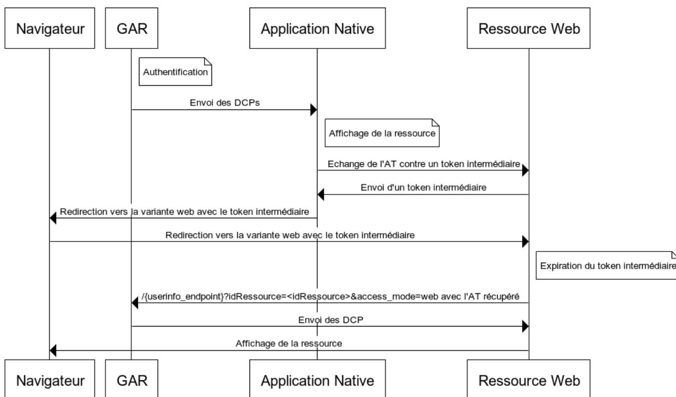
Figure 19 - Accès web par l'intermédiaire d'un Access Token
