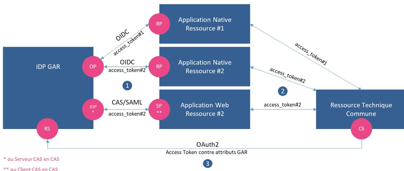
Figure 3 - Schéma de principe d'échange d'Access Token entre RTC et ressources utilisateurs
