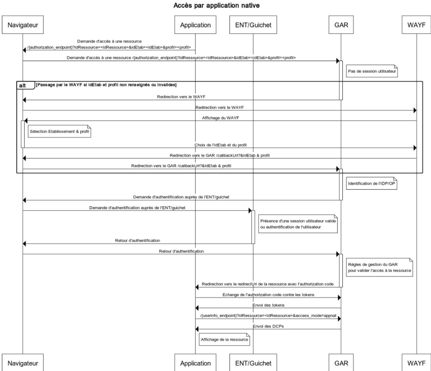
Figure 5 - Diagramme de séquence - Accès par application native
